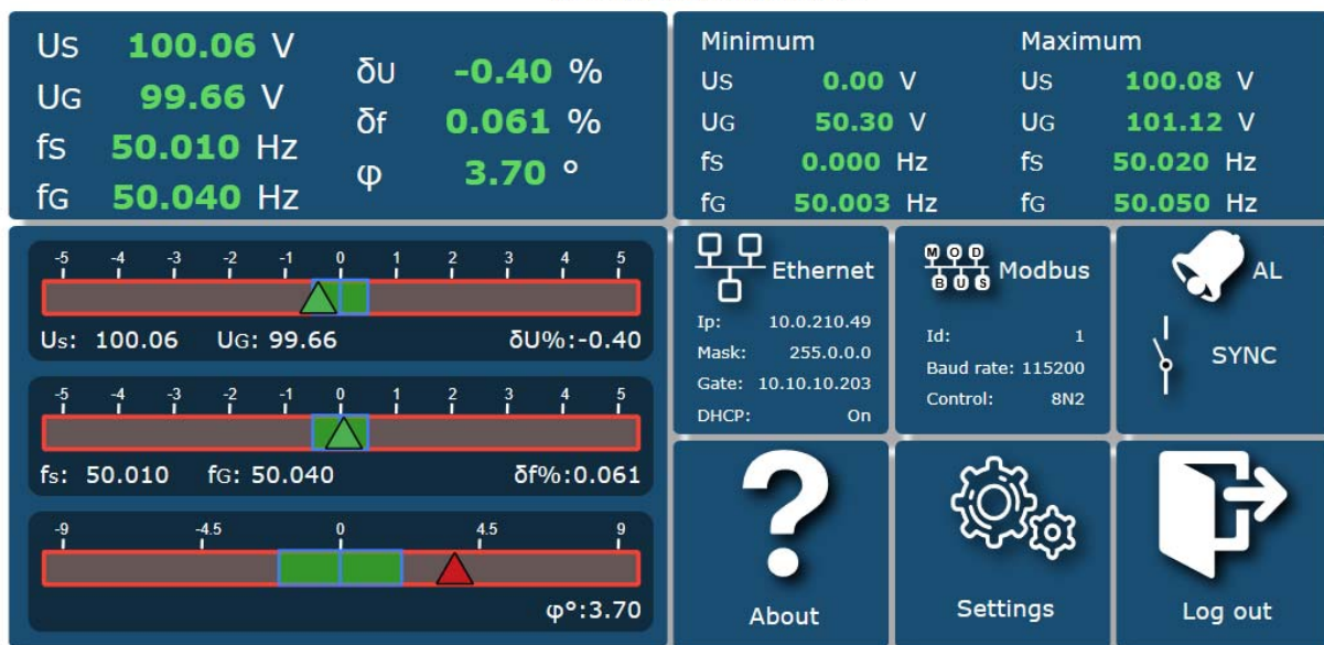
NS5 synchronization meter
